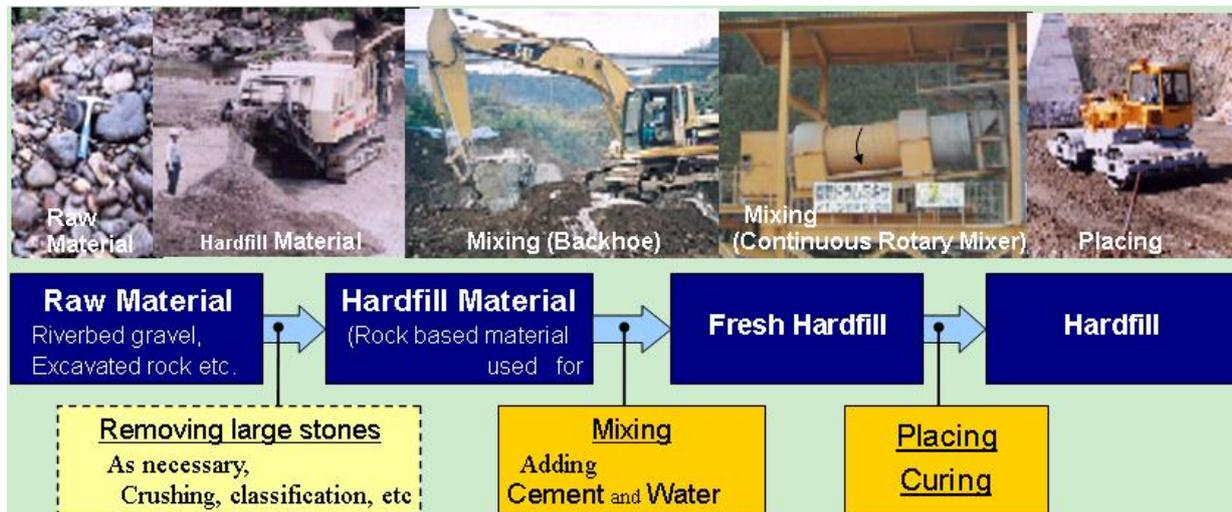
**Fig. 1** Hardfill production process
